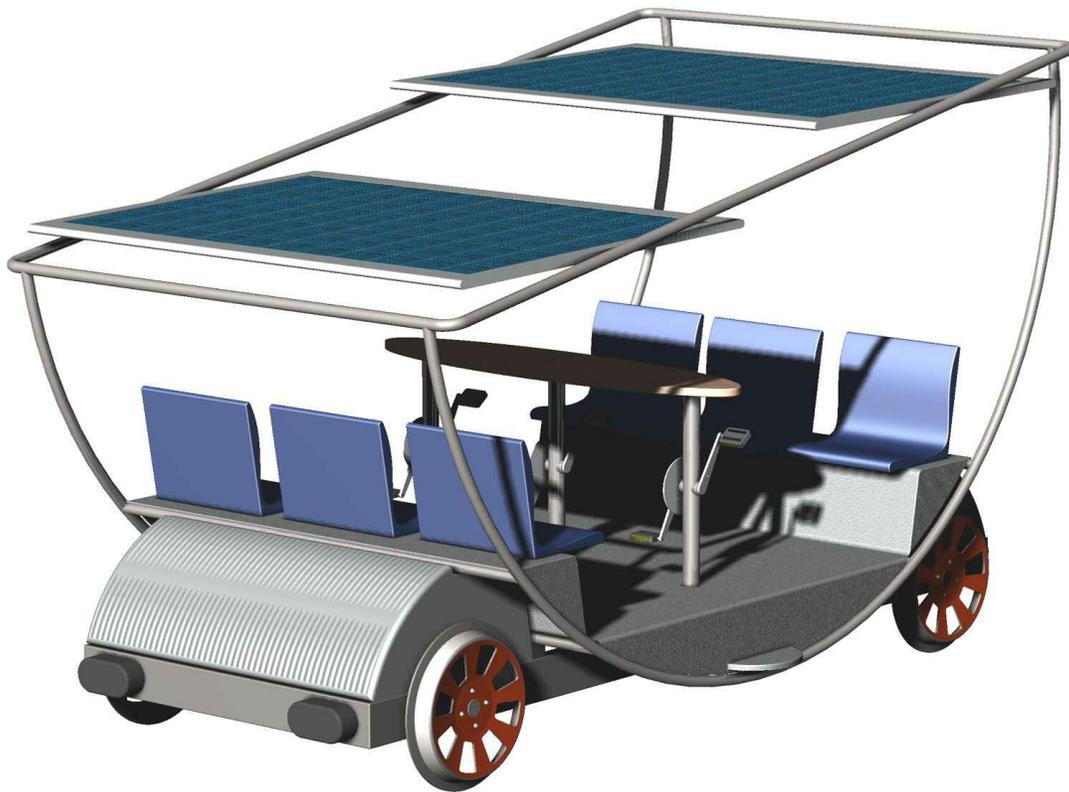
Abb. 9: Die Solar-draisine für 6 Personen mit Pedelec-Antrieb und schwenkbarem Solardach (Quelle: [www.mobikon.de](http://www.mobikon.de))
