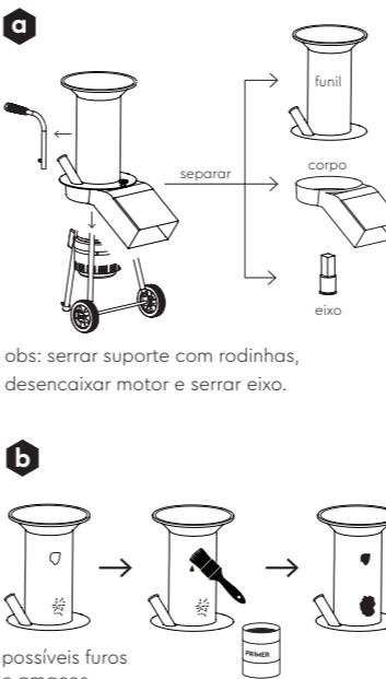
a desmontar a trituradora TR 200: desparafusar e guardar o funil de alimentação, o corpo do triturador e o eixo.
